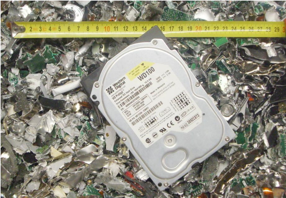
Vor und nach dem Schreddern mit der Zerkleinerungsanlage JBF HD 15/40 bzw. JBF HD 20/40
